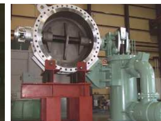
タービン主蒸気止メ弁 (バタフライ弁型)
